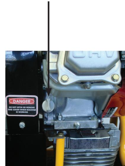
**C. Cheque o nível de óleo do compressor. O nível deve estar no topo da linha do nível de óleo. Se for necessário adicionar óleo, use somente óleo para compressores de ar sintético**
