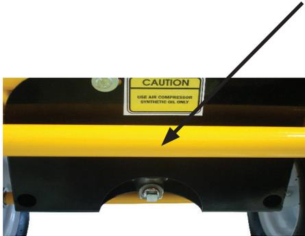
**D. Cheque o nível de óleo do sistema hidráulico. Óleo deve estar no topo da linha do medidor de óleo. se for necessário adicionar óleo use somente óleo AW32 ou DTE 24 para hidráulicos.**
