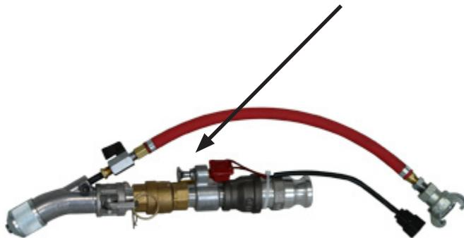
**12. Torça a válvula de velocidade hidráulica no sentido anti-horário.**
